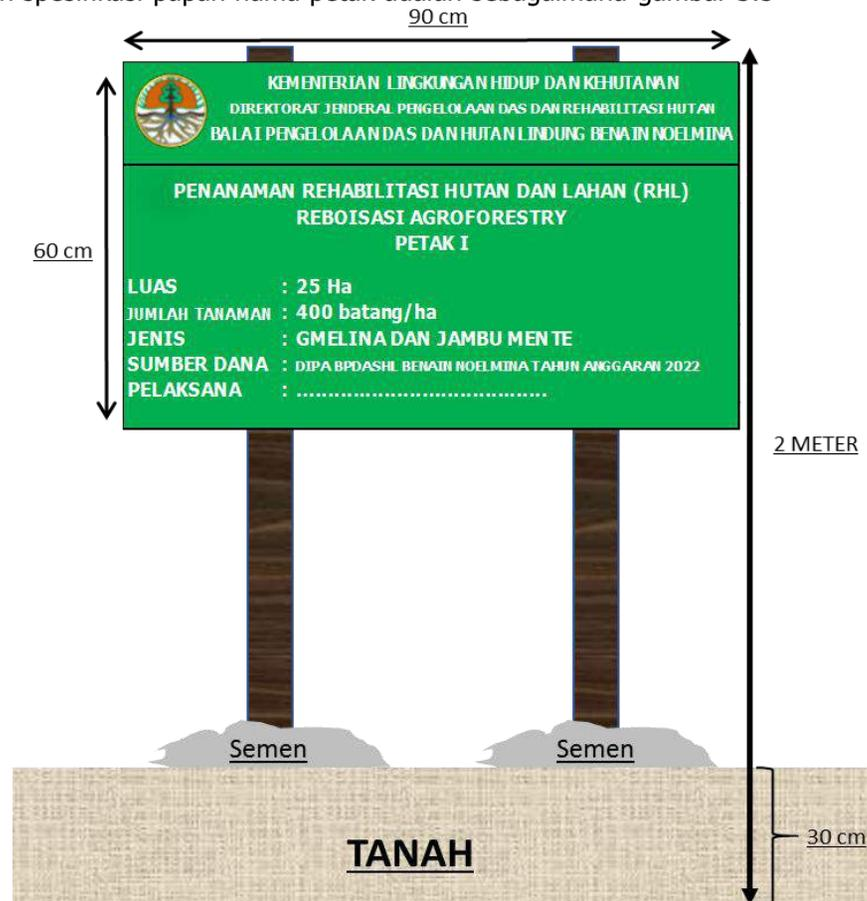
Gambar 3.5 Spesifikasi Papan Petak
